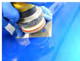
2. Maintenir par pression le pochoir et poncer avec un grain fin (P1000).
