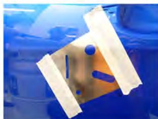
2. Positionner le pochoir sur le défaut et le maintenir à l'aide de bande cache.
