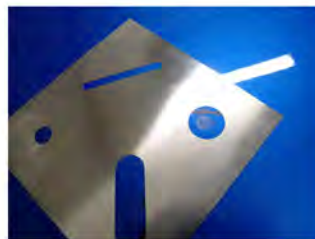
3. Utiliser l'alésage supérieur et poncer avec un grain plus fin (P2000).
