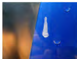
4. L'épaisseur du défaut est largement diminuée, il peut être polshié. Le pochoir a isolé le défaut et a protégé le reste de la surface.
