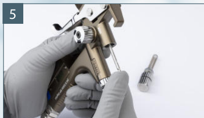
Monter l'aiguille de peinture
